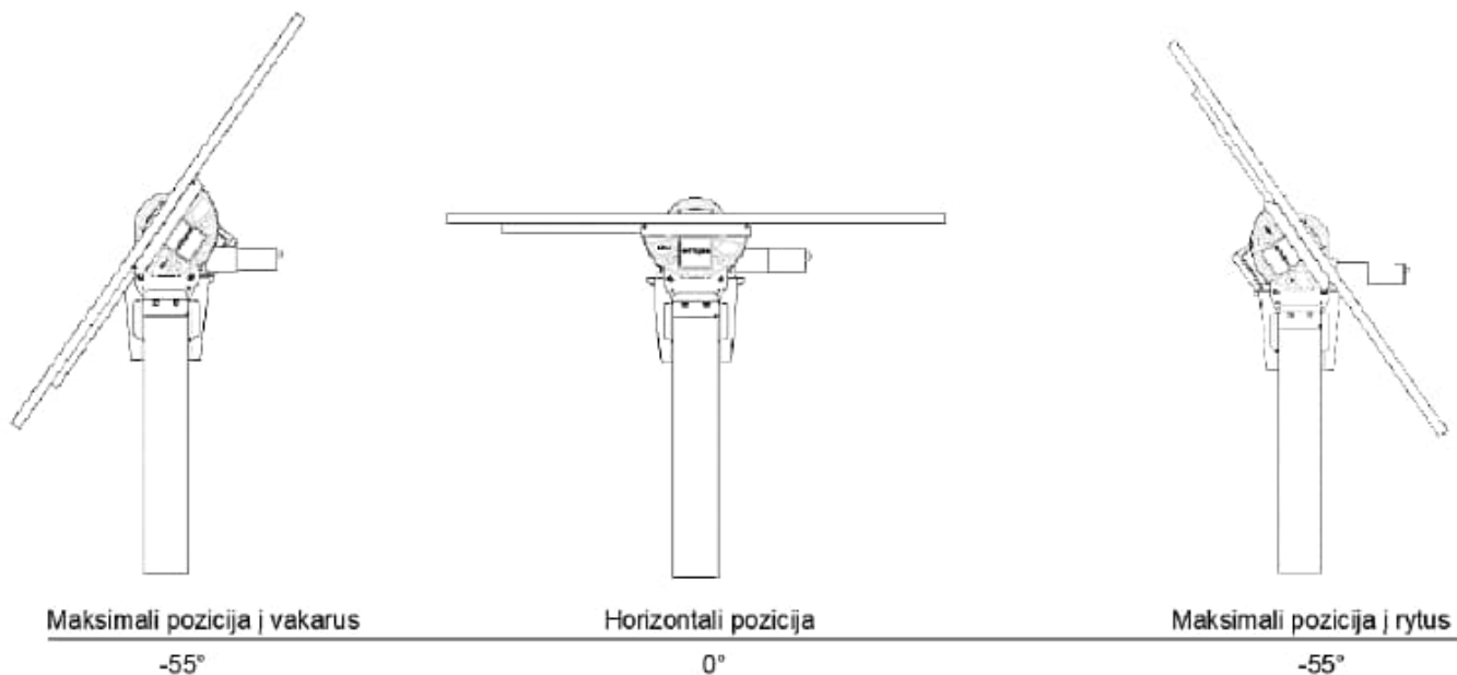
Pav. 1. Konstrukcijų pasisukimo kampas
