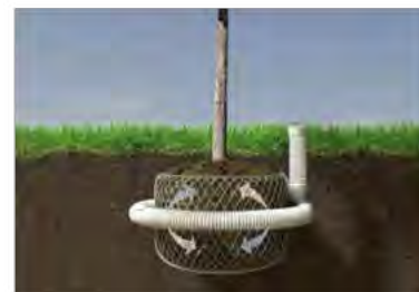
Pav.2 Principinė aeravimo sistemos schema
