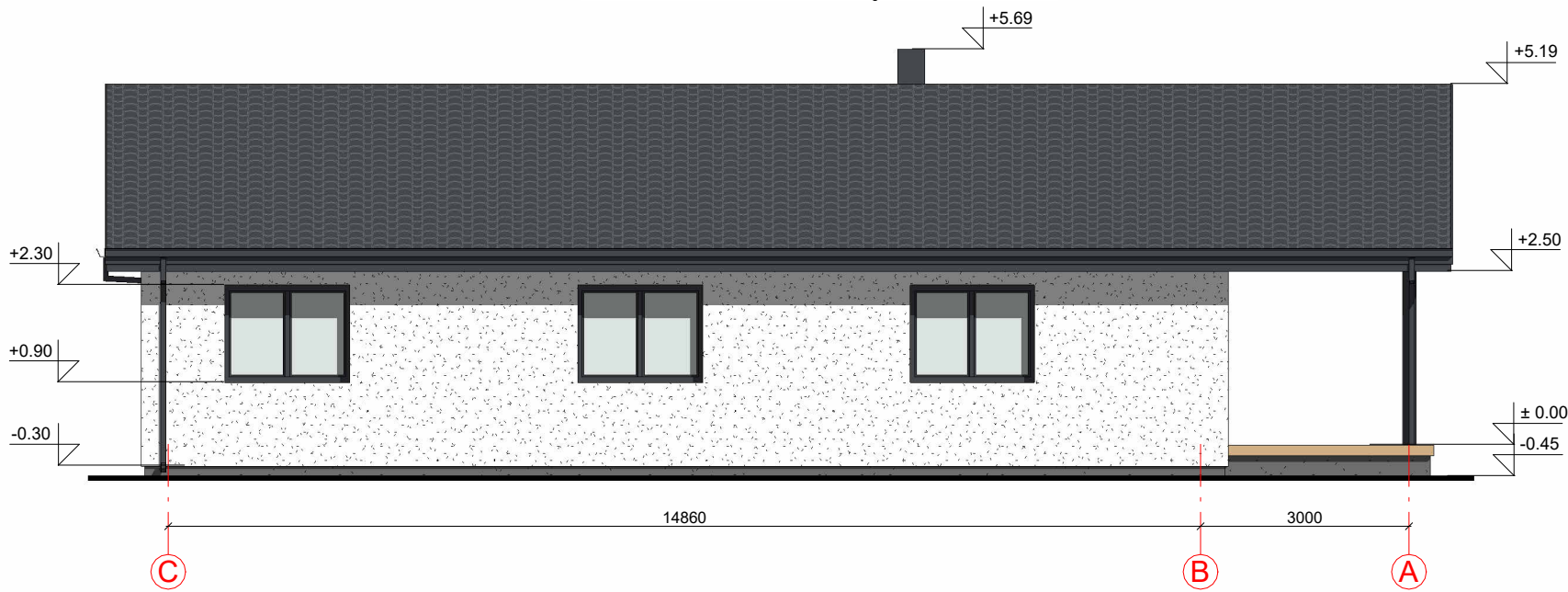
FASADAS TARP AŠIŲ C-A M 1:100
