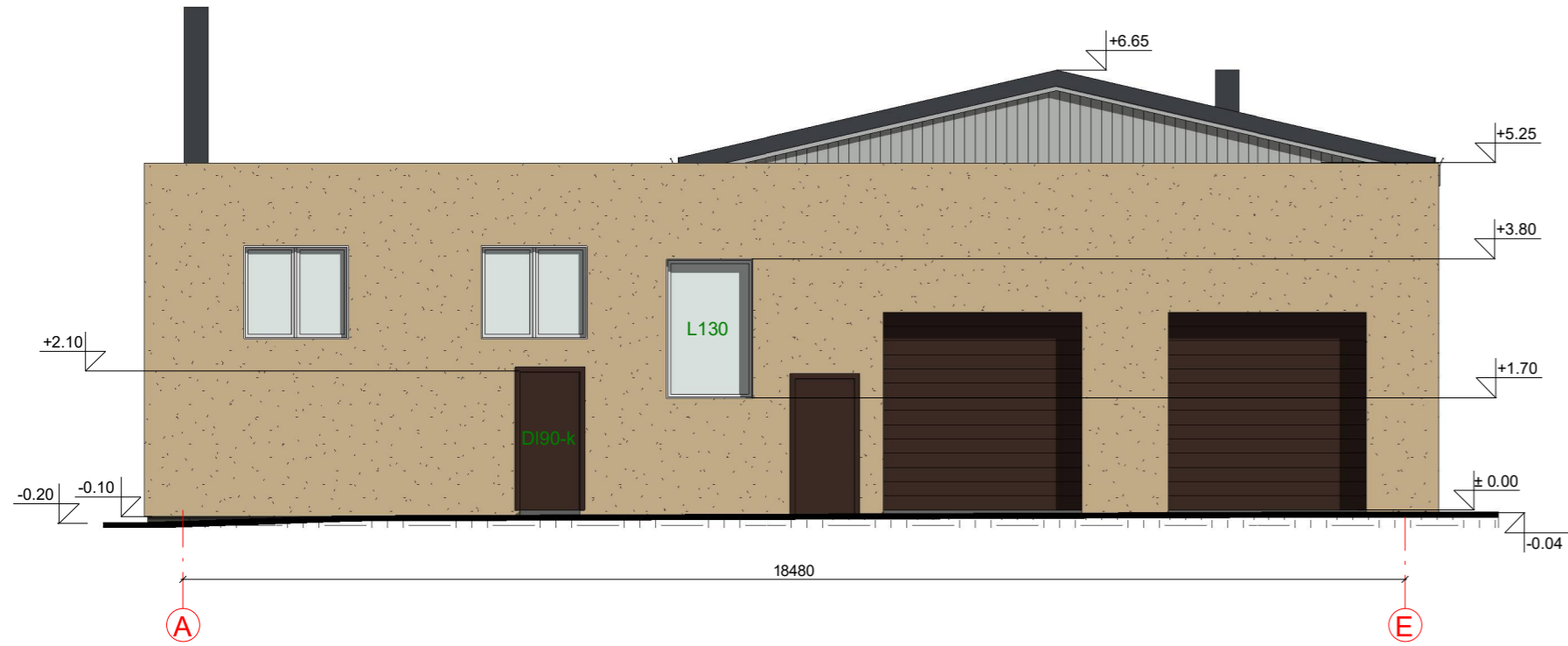
FASADAS TARP AŠIŲ A-E M1:100
