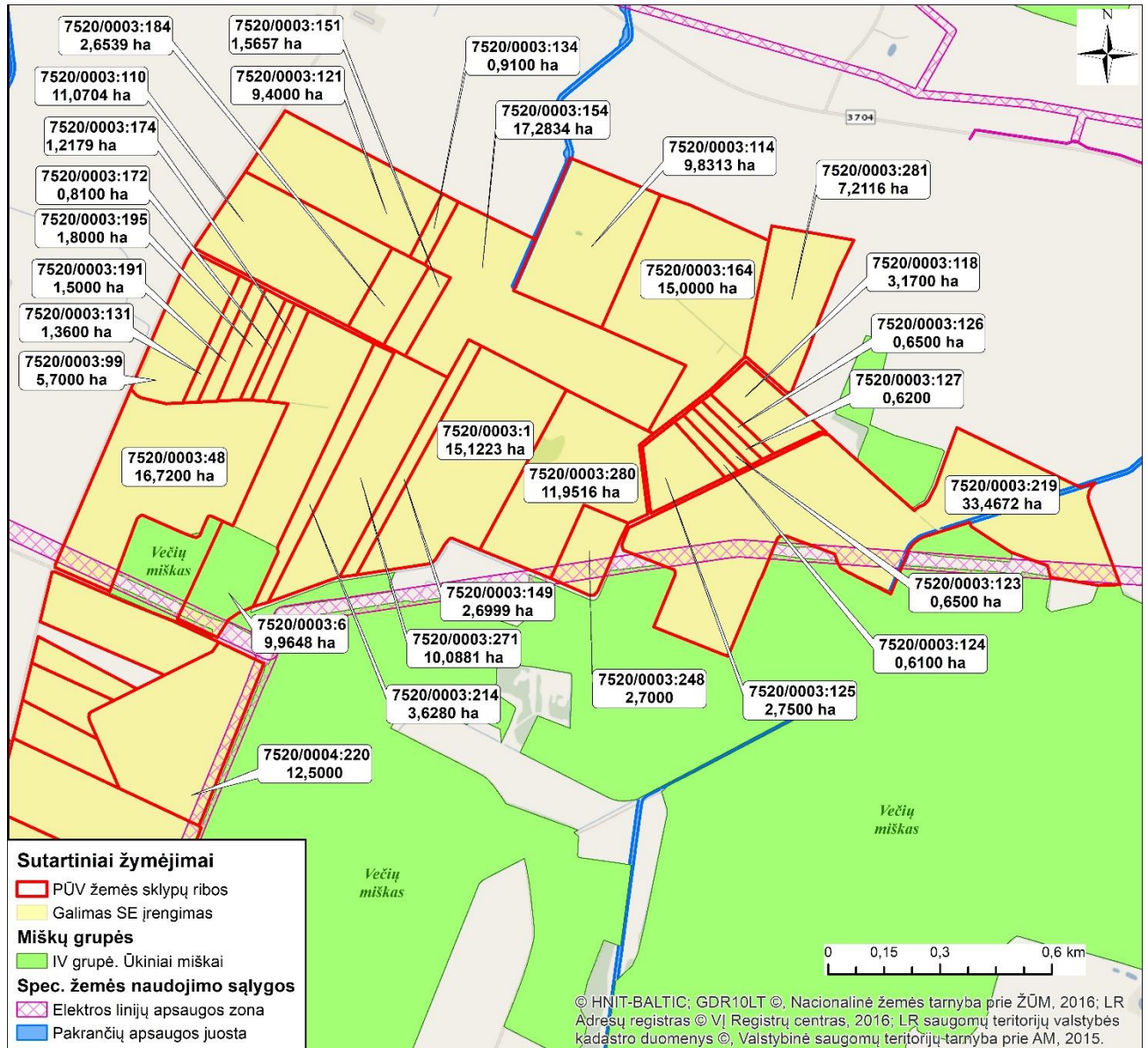
4.13.1 pav. PŪV žemės sklypų išsidėstymas, potencialūs veiklos apribojimai bei saulės modulių įrengimui tinkami plotai sklypų ribose.
