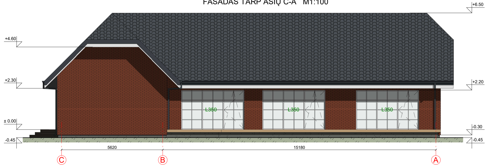
FASADAS TARP AŠIŲ C-A M1:100
