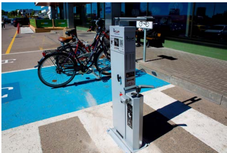
4. pav. Dviračių remonto stotelės įrenginys
