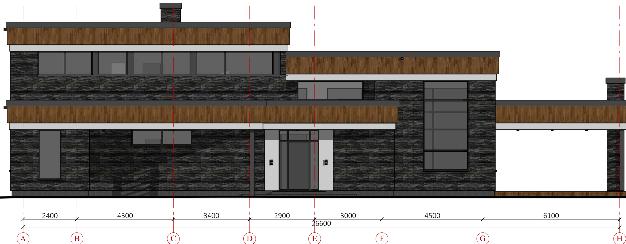
Pietvakarių fasadas tarp ašių A-H, M1:100
