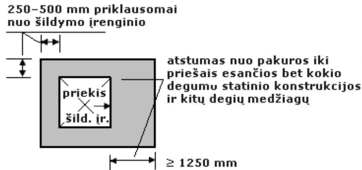
4 pav. Atstumo tarp šildymo įrenginio ir statinio konstrukcijos ir kitų degių medžiagų nustatymo principas
