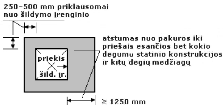
6 paveikslas. Atstumo tarp šildymo įrenginio ir statinio konstrukcijos ir kitų degių medžiagų nustatymo principas
