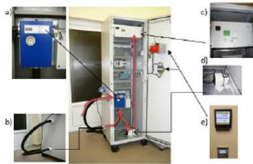
Amoniakso dujų koncentracijos matavimo sistema lazeriniu analizatoriumi GME700: a) elektra šildomos trikanalės skliedės; b) šildomos oro tiekimo žarnos; c) lazerinis amoniako dujų analizatorius; d) membraninis oro siurblys; e) valdymo ir tikrinimo programines įrangos blokas; → oro tiekimas į analizatorių
