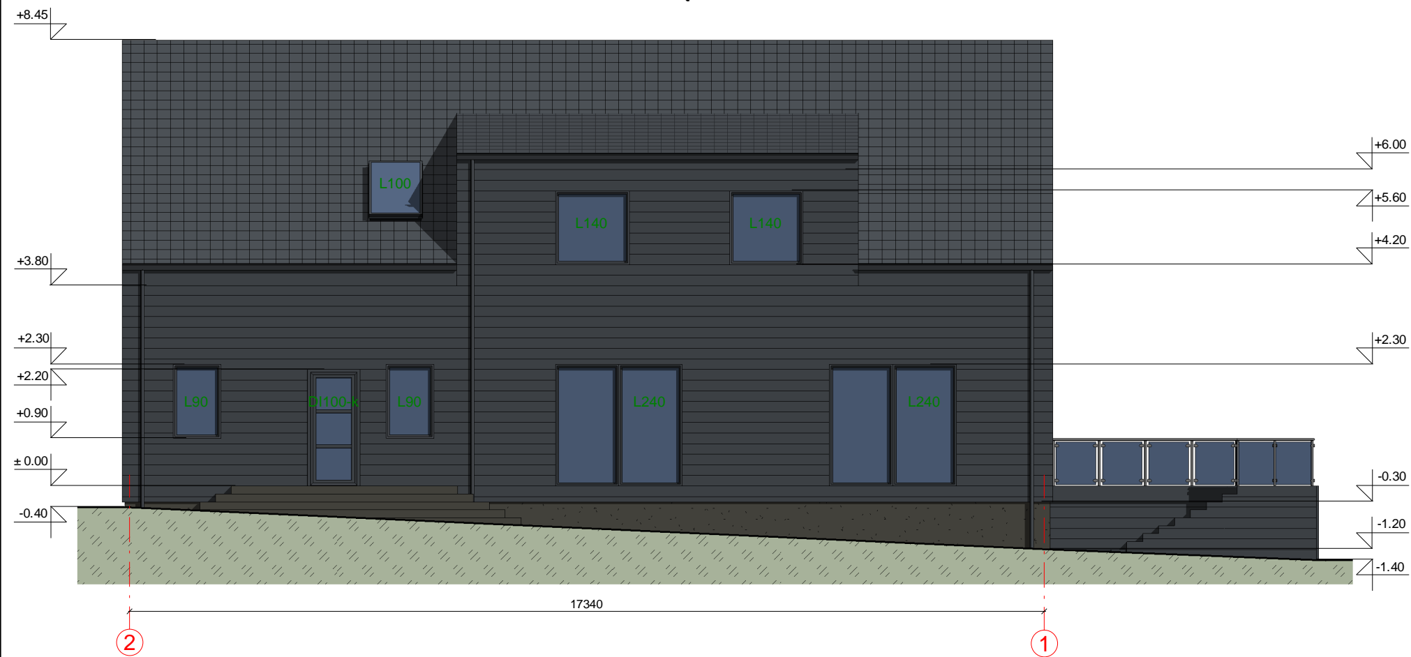
FASADAS TARP AŠIŲ 2-1 M1:100
