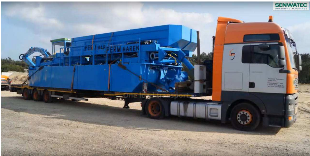
2.3 pav. Sapropelio siurbimo valtis atvežama sunkvežimiu.
